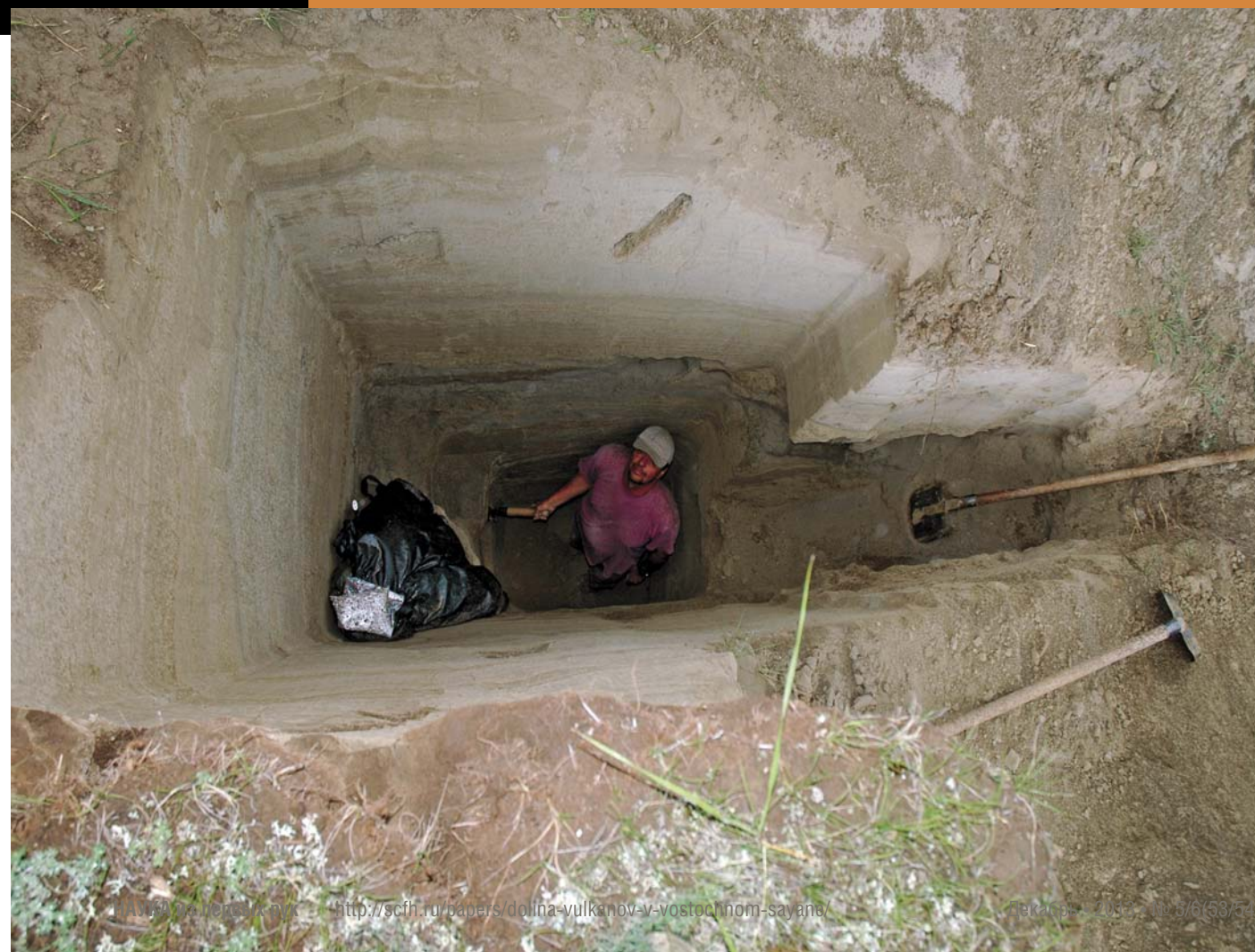
Шурф, заложенный в осадках подпорного водоёма. На глубине двух метров был обнаружен углистый фрагмент, достаточный для радиоуглеродного датирования
