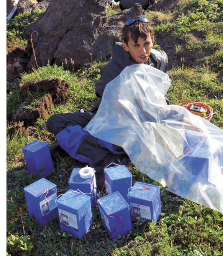
Главными элементами сейсмостанций, установленных на вулкане Горелый, является регистратор «Baikal» и сенсор СМЕ 4111 отечественного производства (внизу). Эти приборы на целый год закапывают в землю. Для обеспечения непрерывной работы одной сейсмостанции требуются несколько батарей общим весом 40 кг (вверху)
