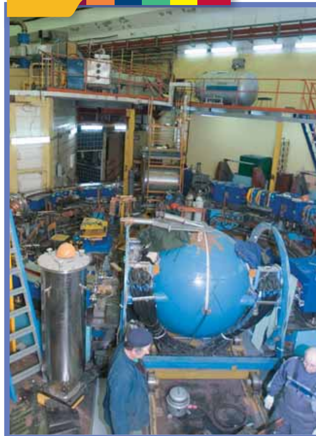
Бустерный синхротрон Б-4, где происходит предварительное ускорение электронных (позитронных) пучков до энергии инжекции (360 МэВ) в накопитель ВЭП-3
