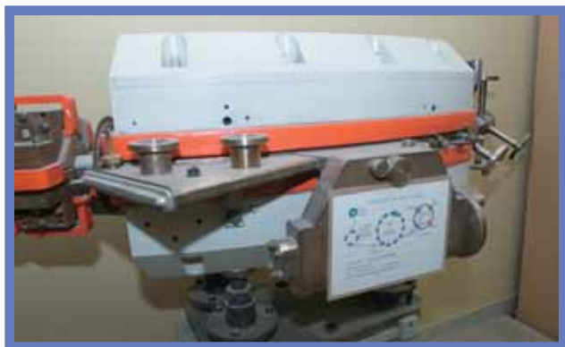
Комплекс ВЭП-2М работал в диапазоне энергий 0,4 — 1,4 ГэВ. Максимальная достигнутая светимость — 5 \times 10^{30} \text{ см}^{-2} \times \text{сек}^{-1} на энергии 510 МэВ. В 1972 г. заработал новый ускоритель ВЭП-2М. Внизу — поворотный магнит ускорителя ВЭП-2, ставший музейным экспонатом
