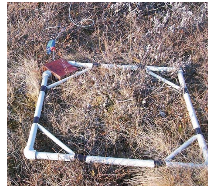
Оборудование для зондирования становлением поля в ближней зоне. Приемный датчик ПДИ-50 – эквивалент петли 50×50
