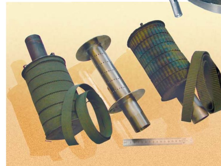
Реактор для окисления метана в синтез-газ на ленточном катализаторе. Объем реактора — 4 л, расход смеси «метан + воздух» — 55 м 3 /час, рабочая температура — до 850°C
