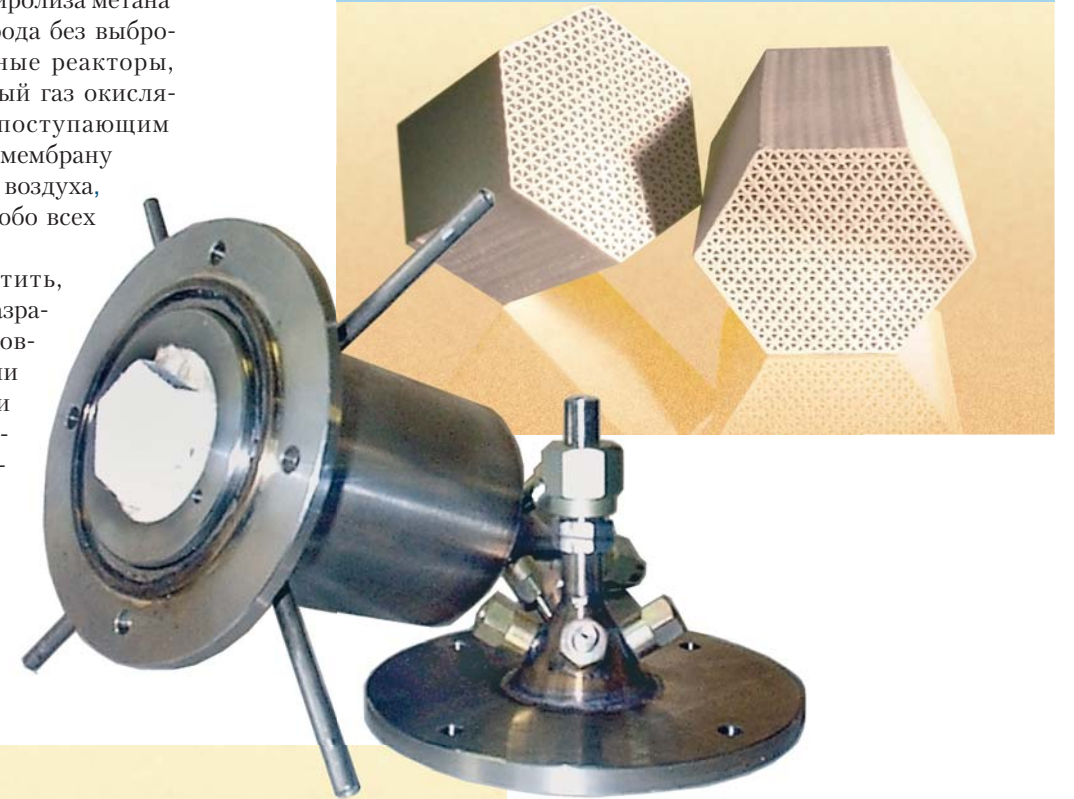
Реактор для окисления метана в синтез-газ на блочном катализаторе. Объем реактора — 300 мл, расход смеси «метан + воздух» — 4 м 3 /час, рабочая температура — до 1200°C
