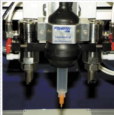
Так выглядит биопринтер производства компании CUSPIS LLC, Южная Каролина, США для печати тканевых конструкций живыми клетками пациента
