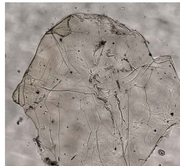
Фторографен – перспективный полупроводниковый материал – можно получить отделением тончайших слоев-чешуек ( слева ) от массива фторида графита, где слои материала «раздвинуты» различными «гостевыми» молекулами. Справа – фторид графита, интеркалированный ацетонитрилом, с хорошо выраженной слоистой структурой. Оптическая микроскопия
