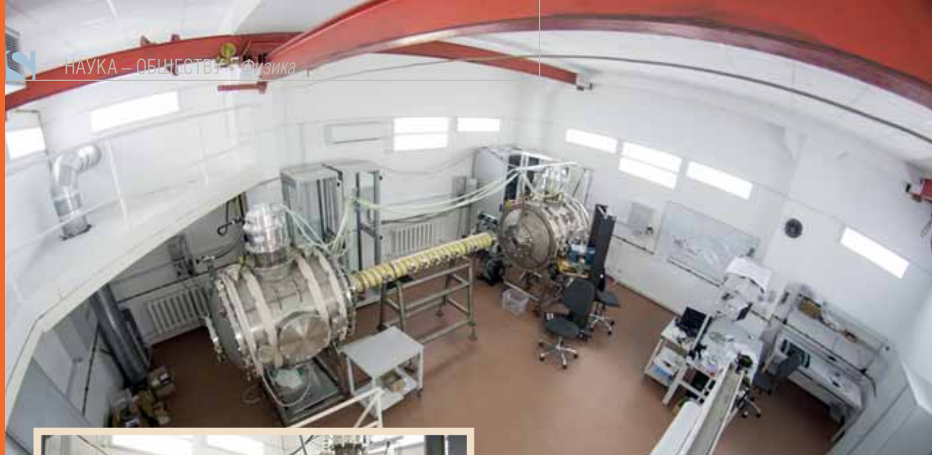
Установка СМОЛА на этапе сборки. Слева и справа от винтовой секции – баки источника и приемника плазмы
